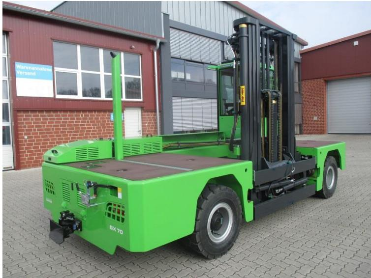
*Duo-Matic-Schnellkupplungen an Heck und Front ermöglichen ein schnelles und sicheres Ankuppeln.*
