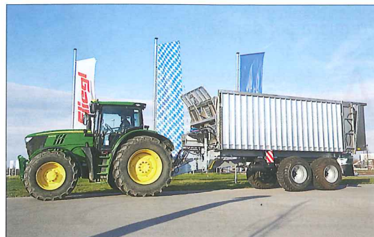
Abschiebewagen mit mehr Nutzlast dank Aluminiumbauweise.
