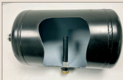
Luftbehälter mit automatischem Entwässerungsventil.
