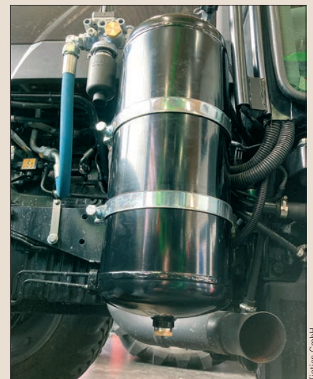
Luftbehälter mit automatischem Entwässerungsventil an einem Traktor.
